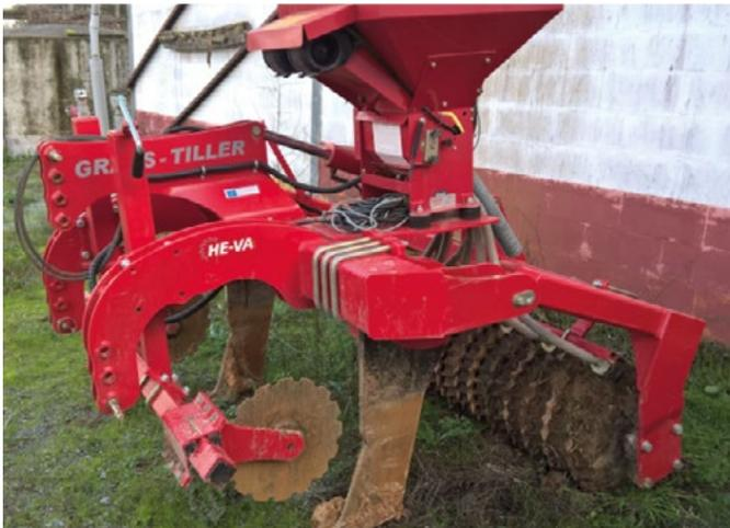
Subsolador de 3 ripper con sistema de siembra directa o aplicación de fertilizante
